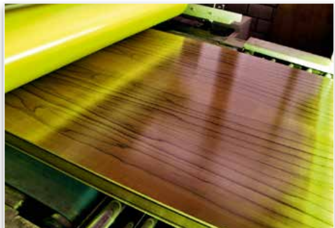
Lackauftragswalze und UV-Lampe
